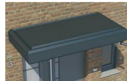
Diese Vordächer eignen sich durch ihre Maßanfertigung besonders zum Verkleiden alter Betonvordächer. Sie können aber auch durch eine Tragarmmontage an jeder Wandfläche angebracht werden. Bei diesen verschweißten Aluminium-Konstruktionen ist eine für den Betrachter unsichtbare Wasserrinne in die Dachfläche integriert. Durch diese Rinne kann das Wasser nach vorne über einen Wasserspeier oder wandseitig über ein Fallrohr abgeleitet werden.
